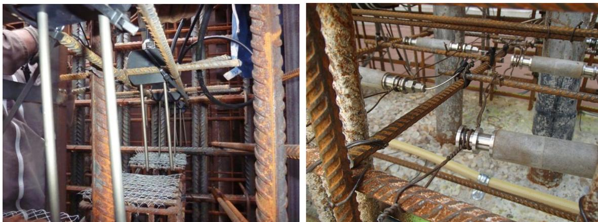
Figure 5 - Sondes TDR (à gauche) et pulse (à droite) mises en place avant bétonnage
