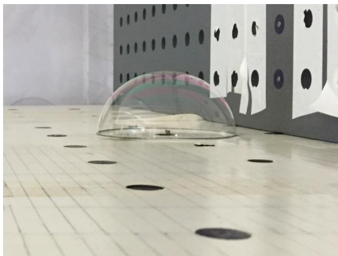
Figure 2 Charge explosive hémisphérique et capteurs de pression sur le plan-mur (pastilles noires)
