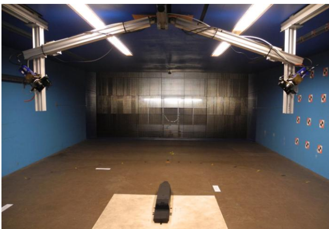
Figure 4 : Implantation du système de prise de vues stéréoscopique.
