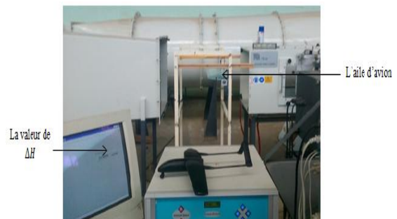
Figure 8. Le montage d'expérience dans la soufflerie
