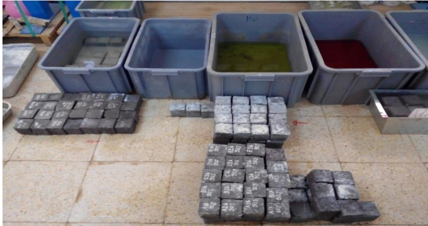
Figure 6. Cures des éprouvettes dans les solutions chimiques
