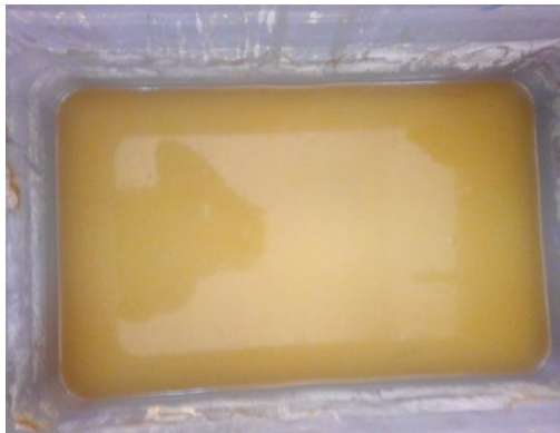
Figure 9. solution d'acide sulfurique et débris de bétons
