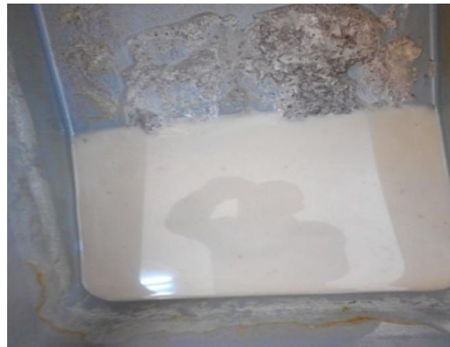
Figure 9. solution d'acide sulfurique et débris de bétons
