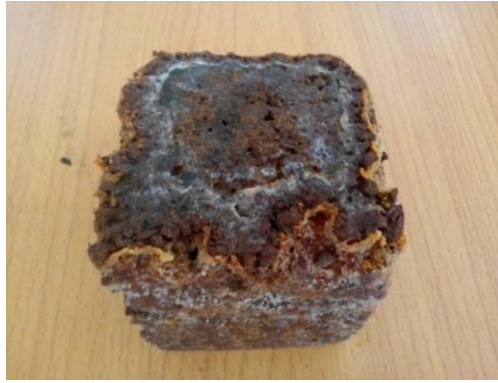
Figure 8. Altération de l'éprouvette en béton
