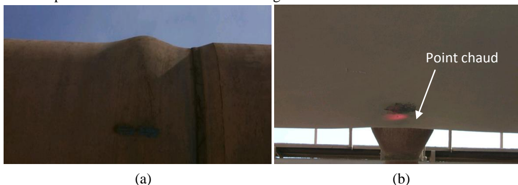
Fig. 1-3 : (a), Virole ovalisée – (b), Apparition du point chaud
