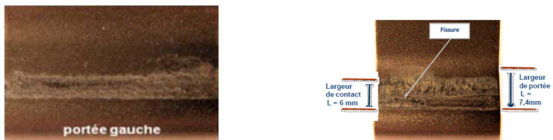
Figure 6: Photographie de portée de dent de disque après essai : dissymétrie entre les portées gauche et droite (usure plus locale à gauche)
