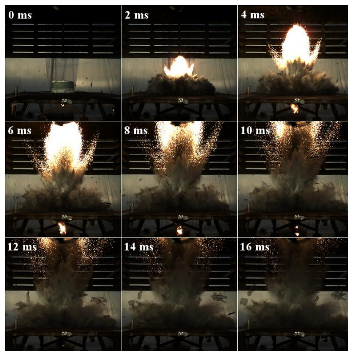
Figure 4. Images d'un essai avec un petit confinement et un foisonnement de 60
