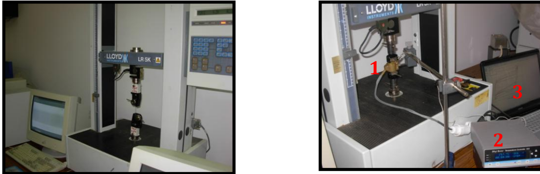
Figure 1 - Machine LLOYD de traction (a) - Essai de traction des fils à T=25^{\circ}\text{C} , 37^{\circ}\text{C} et 50^{\circ}\text{C} avec 1 est le collier chauffant, 2 est le régulateur de la température et 3 est le logiciel « temperature controller » qui pilote la régulation de la température (b).
