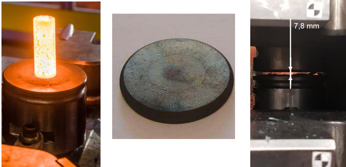
Figure 5 : Photo des opérations de refoulement et des outillages en position fermée
