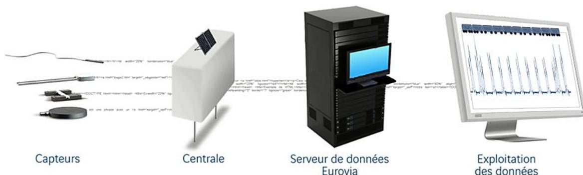
Figure 1. Illustration du principe de fonctionnement du dispositif Smartvia® Track.
