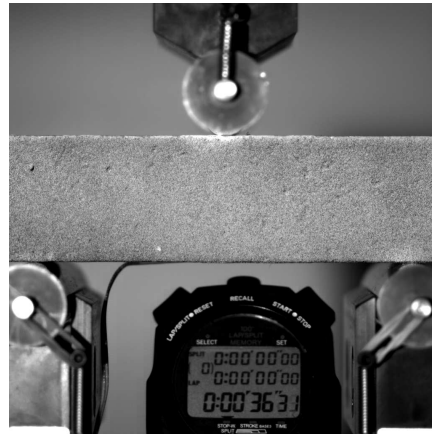
FIGURE 7 – Essai de flexion 3 points sur une éprouvette de béton.
