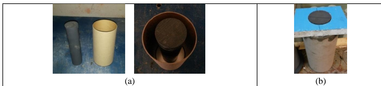
Figure 3. Cylindre PVC fixé centré au fond du moule en carton (a) et cale assurant le centrage du cylindre (b)
