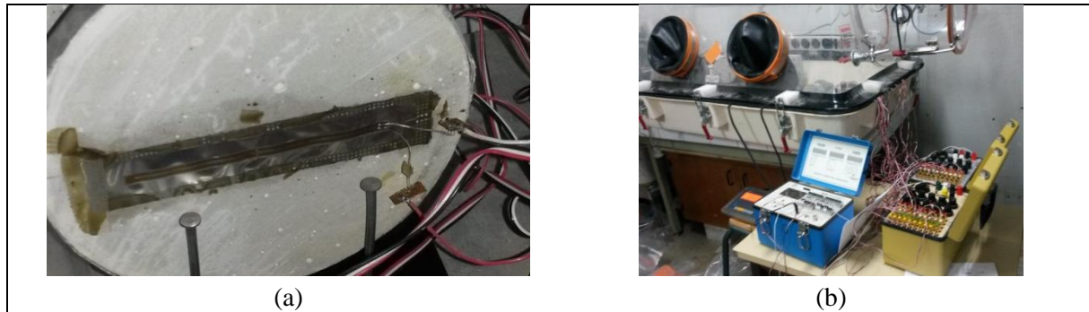
Figure 1. Illustration d'une jauge d'extensométrie collée sur un échantillon (a) et dispositif de suivi des mesures de déformations (b)
