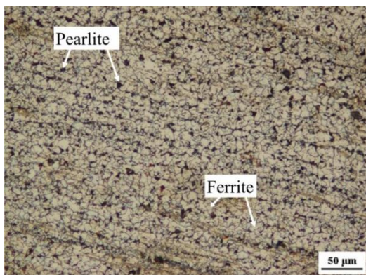
Fig.3 Micrographie optique du métal de base de l'acier HSLA API X52
