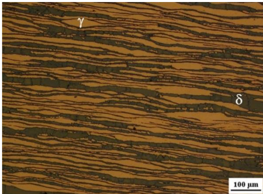
Fig.1 Micrographie optique du MB de l'acier inoxydable duplex 2205
